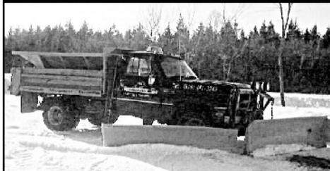
Camion Dodge RAM 1993, 4x6, 198 000km, boîte dompeur 7'x9' avec côté rabattable, cylindre télescopique, pelle avant Fisher 8', lame de recul, côté rabattable, pompe 7 gallons, sorti hydraulique arrière, moteur Cumming 5.9l,
