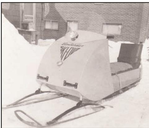
Marcel L'Écuyer a acheté sa première motoneige en 1960. C'était une Bombardier avec un moteur Koler à quatre temps et il fallait une poulie pour le partir. Il l'avait payée 650 \$ et elle filait à la vitesse vertigineuse de 30 milles à l'heure.
