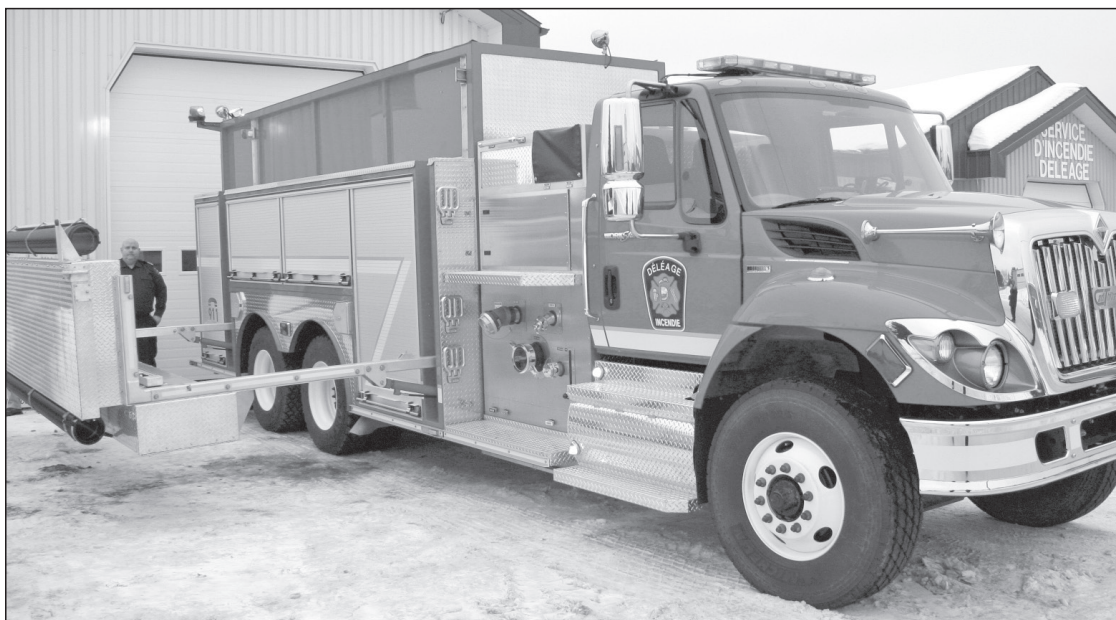
Le nouveau camion dans toute sa splendeur. Le bras hydraulique contient les échelles et la piscine.
