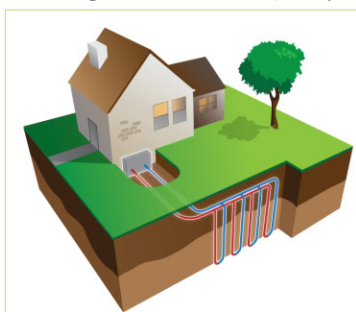
Illustration d'un système géothermique dont l'échangeur de chaleur est une boucle en circuit fermé à la verticale
