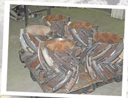
Rouleau d'écorceur découpés et montés en atelier
