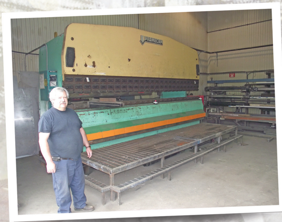
Plieuse peut plier 16" de large 3/8 d'épaisseur 200 tonnes
